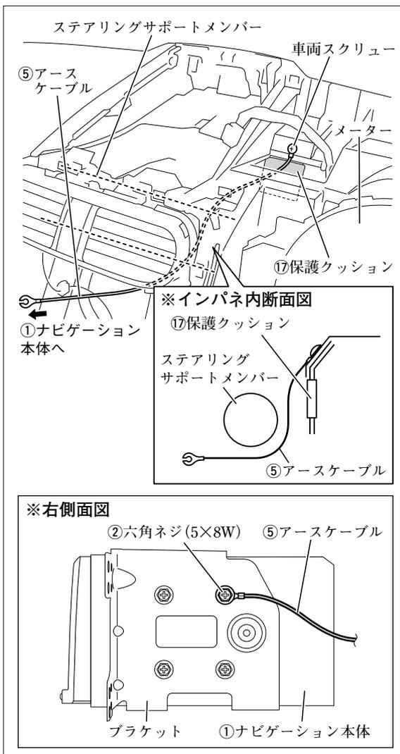
(1) ⑤アースケーブルを図のように配線し、片側をメーター左側の車両スクリューと共締めしてください。
