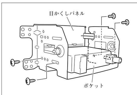
スクリー (左右各2か所) を外して、ポケット及び目かくしパネルをブラケットから取り外してください。
