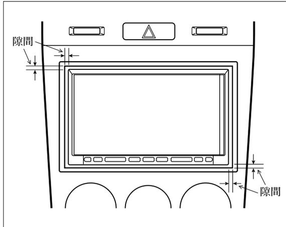
ナビゲーションを取付け、ガーニッシュを取付けた後、必ずナビゲーションのモニター部とガーニッシュの上下左右の隙間を確認してください。隙間がないと、モニターの開閉時にガーニッシュと擦れたり、特に下側に隙間がない場合は、モニターの開閉はできてもチルトができないという症状が発生します。
