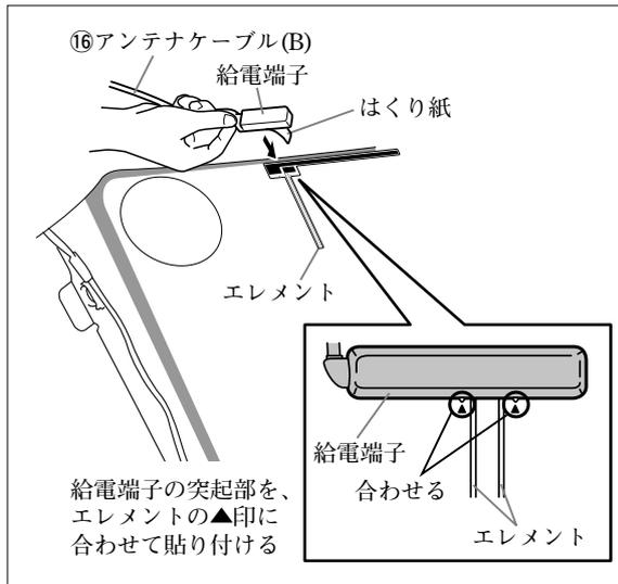
⑩アンテナケーブル(B)の給電端子のはくり紙をはがして、エレメントの給電部の▲印と給電端子の先端の突起部を合わせながら、給電端子をエレメントに取り付けてください。
