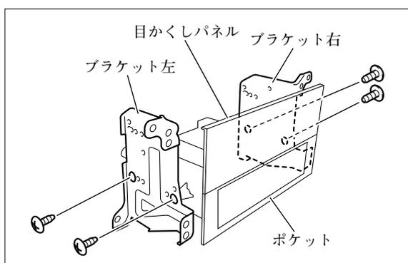
スクリー (左右各2か所) を外して、ポケット及び目かくしパネルをブラケットから取り外してください。
