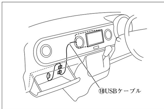
2 (1) グローブボックス内に⑱USBケーブルが約200mm残るように、グローブボックス裏面に⑨ハーネス固定テープで固定してください。
