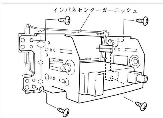
ブラケットを固定しているスクリー (4か所) を外し、インパネセンターガーニッシュを取り外してください。
